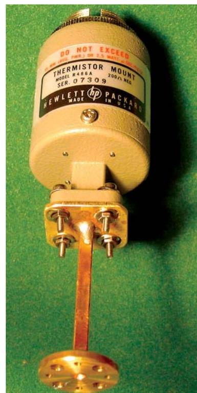
**Bild 8:** HP R486A Thermo-Messkopf mit angeschraubtem Hohlleiter WR 12
