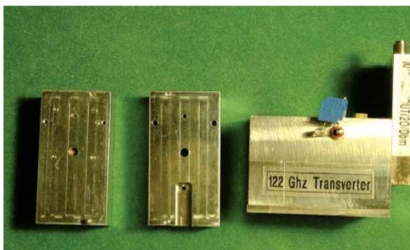
Bild 3: Ansicht des 122-GHz-Transverters (Außenseiten)
