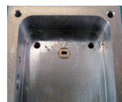
Bild 7: Mixer-Gehäuse mit WR 7, abgefräst (rectan- gular)
