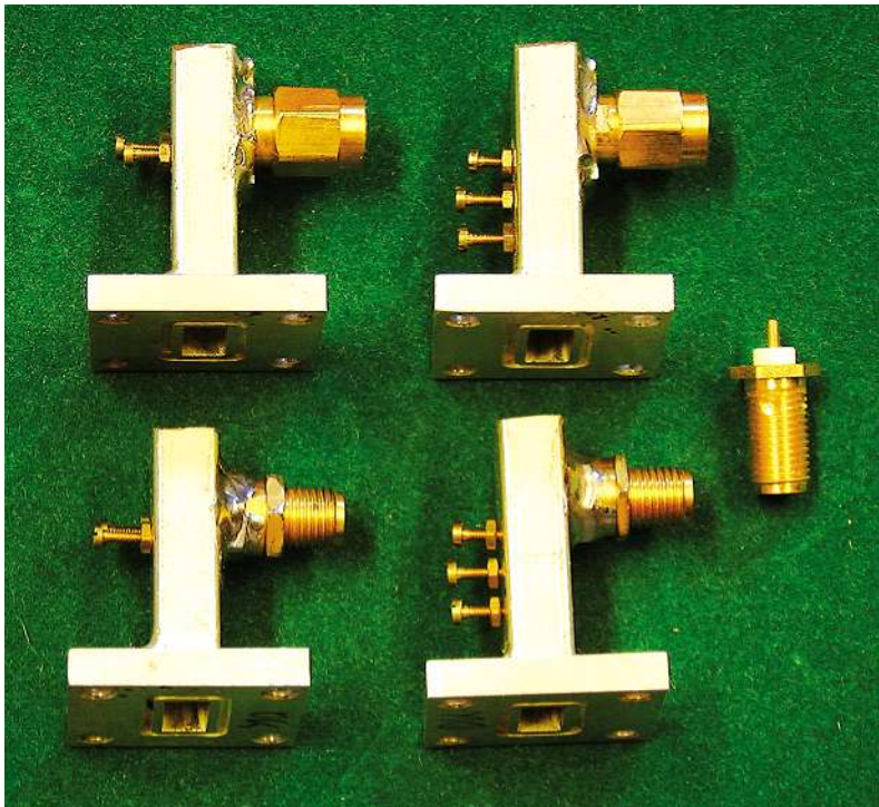
Bild 5: Beide Hohlleiterübergänge im Vergleich und daneben die Einbaubuchse
