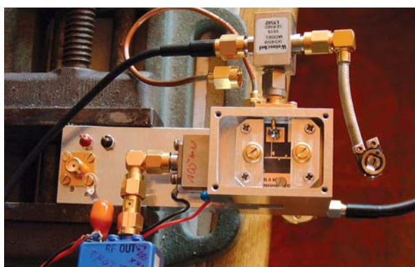
Bild 3: Messaufbau mit Potenziometer zur Diodenanpassung
