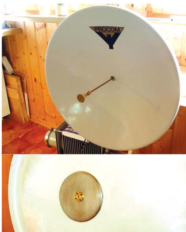
Bild 10: 50-cm-Spiegel von Procom (oben), selbstgedrehte Kalotte (unten)
