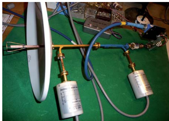
Bild 9: Procom-Parabol mit Cassegrain-Strahler auf 76 GHz mit WR 12 und zwei Messkopplern
