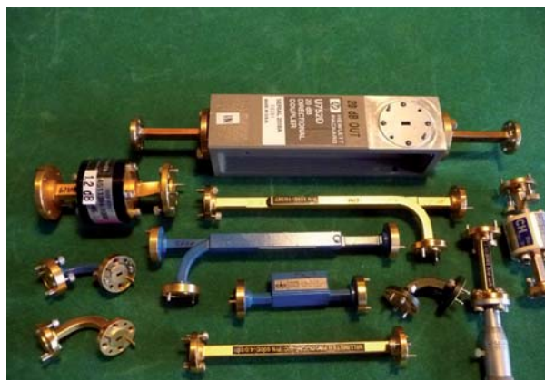
Bild 7: Koppler für 47 und 76 GHz, Mess-Equipment
