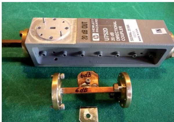
Bild 3: 47-GHz-Koppler und selbst gebautes Dämpfungsglied 6 dB WR 19
