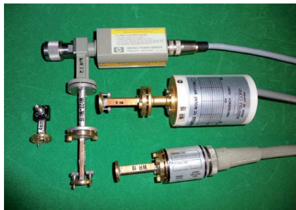
Bild 4: Vergleich von drei verschiedenen Messköpfen für 47 GHz
