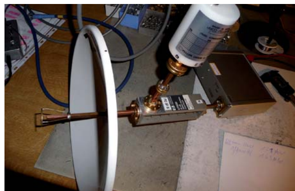
Bild 8: Procom-Parabol mit Cassegrain-Strahler auf 47 GHz mit WR 19
