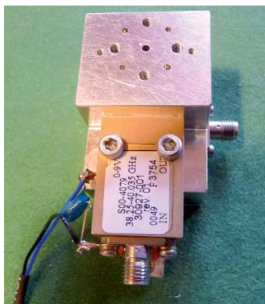
Bild 5: Kleiner Multiplier auf Mischer montiert
