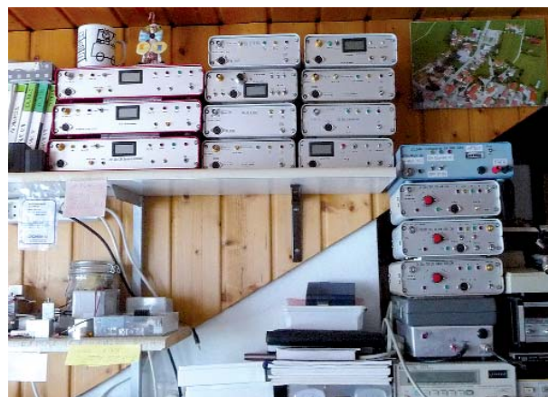
Bild 6: Vom Autor gebaute und verwendeten Transverter von 24–241 GHz
