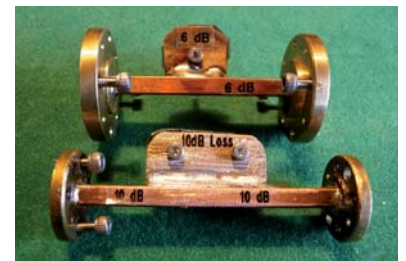
Bild 3: Eigenbaudämpfungsglieder WR 19, 6 dB plus 10 dB
