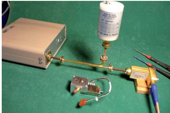
Bild 7: Messen mit Koppler und Thermo-Messkopf WR 12
