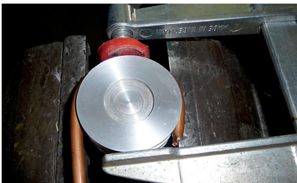
**Bild 1:** Anfertigen eines Rundbogens bzw. ähnliche Krückstöcke für Parabolspiegel WR 19
