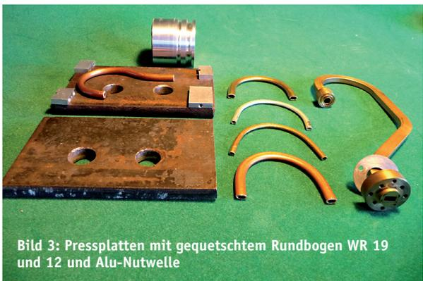
**Bild 3:** Pressplatten mit gequetschtem Rundbogen WR 19 und 12 und Alu-Nutwelle
