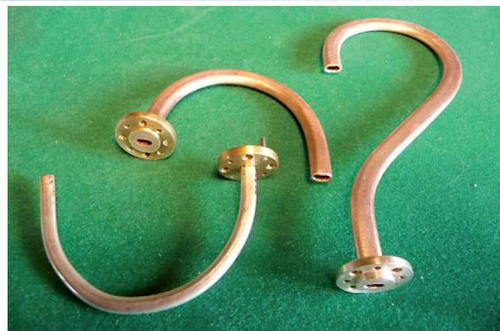
Bild 7: WR 19 und WR 12 mit Flanschen
