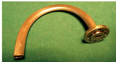
**Bild 5:** Gequetschter Rundbogen WR 19 mit darauf gesetztem Flansch UG387U
