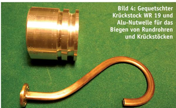
**Bild 4:** Gequetschter Krückstock WR 19 und Alu-Nutwelle für das Biegen von Rundrohren und Krückstöcken
