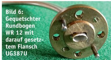
**Bild 6:** Gequetschter Rundbogen WR 12 mit darauf gesetztem Flansch UG387U
