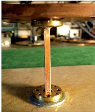
**Bild 10:** Ein HL WR 12 mit Doppelflansch und aufgelegter Kupferplatte
