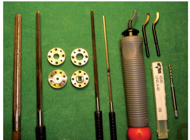
**Bild 4:** Konische Reibahlen und Universal-Entgrater sowie Gewindebohrer UNC 4/40
