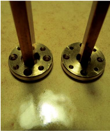
**Bild 9:** Eingeprägte HL WR 19 und WR 12 in Flansch
