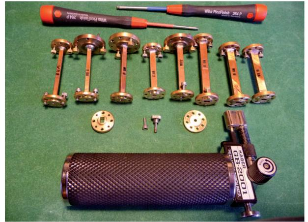
**Bild 11:** HL mit Flanschen, ähnlich WG 387 und WG 383, Flanschverbindungs-Schrauben sowie Rundkopf-Innen-Sechskantdreher
