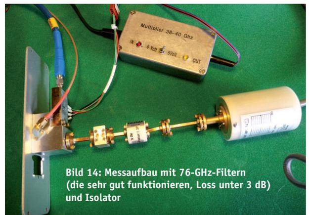
**Bild 14:** Messaufbau mit 76-GHz-Filtern (die sehr gut funktionieren, Loss unter 3 dB) und Isolator
