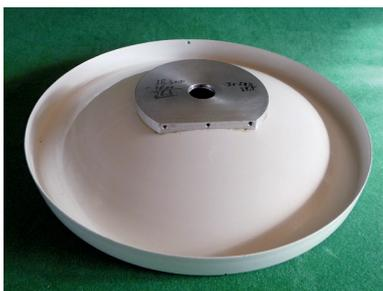
Bild 9: Bearbeitete Aluscheibe auf Parabol aufgelegt
