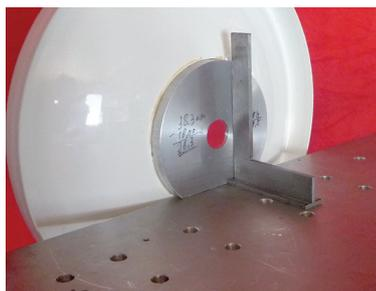
Bild 10: Kontrolle der aufgeschraubten Alu-Scheibe mit Parabol
