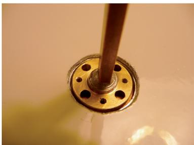
Bild 7: Ansicht bei eingebautem Hohlleiter mit Flansch
