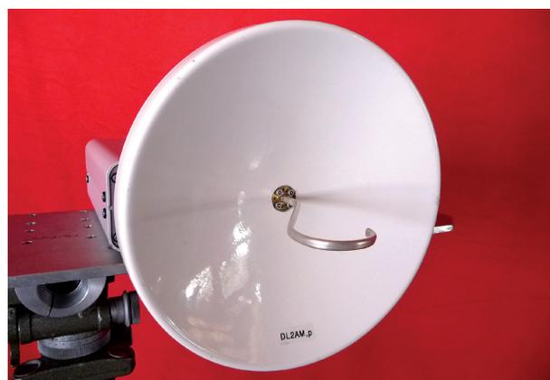
Bild 2: Verwendung von verschiedenen Strahlern im Parabol
