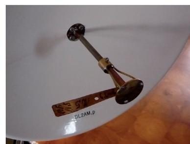
Bild 14: Austausch des Reflektors beim Wechseln der Transverter
