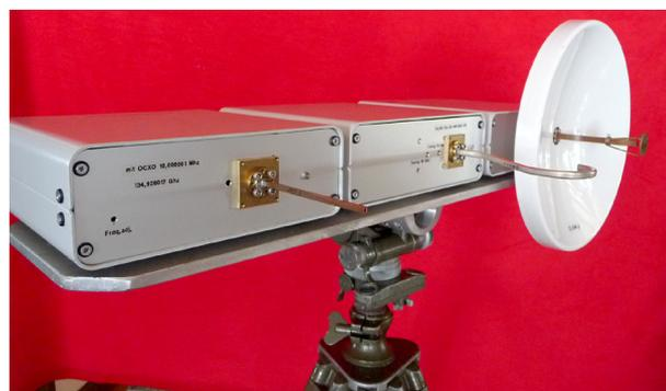
Bild 1: Geräteaufbau für ein QSO mit mehreren Transvertern
