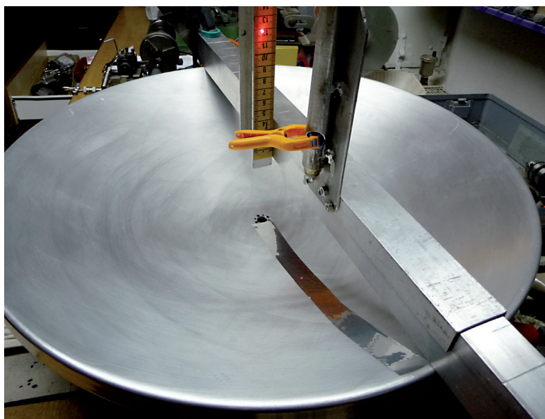
Bild 8: Messeinrichtung für Parabolspiegel
